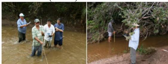
Foto 7: Medição da vazão durante a etapa de calibração de curva-chave.
