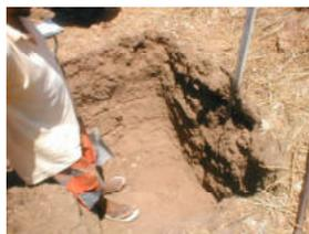
Foto 14: Abertura de trincheira e amostragem
