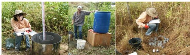
Foto 5: Ensaios de infiltração - anéis concêntricos e "Beerkan"
