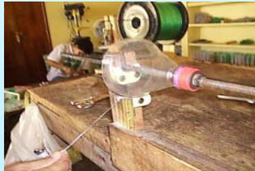
Instrumento de Corte do Pet para Preparação das Cerdas da Vassoura
