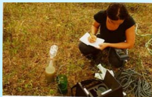
Determinação e Registro no Campo, de Parâmetros de Qualidade de Água, Utilizando Aparelho Portátil
