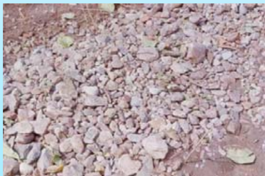
Material de Filtragem de Água (Brita) Usado como Base na Construção do Poço da B.S.
