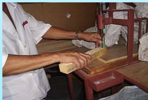
Preparação da Estrutura em Madeira da Vassoura
