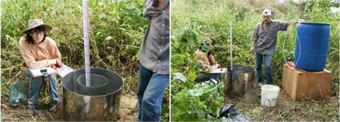
**FOTO 2.10 – Ensaio de infiltração com anéis concêntricos**
