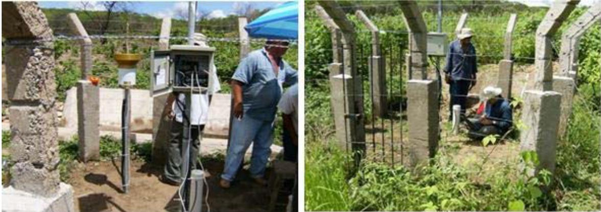
**FOTO 2.06** – Instalação da PCD na calha 02, e realização de coleta de dados e avaliação da calibração do equipamento.
