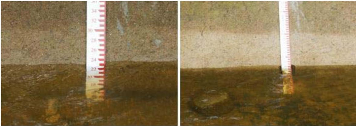
**FOTO 2.13** – Medição do nível d'água na calha do riacho do Salgadinho. Coordenadas geográficas UTM: 0458591 / 9488845.
