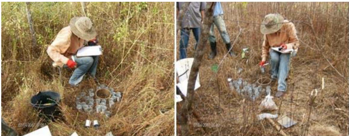
**FOTO 2.11 – Ensaio de infiltração método de “Beerkan**
