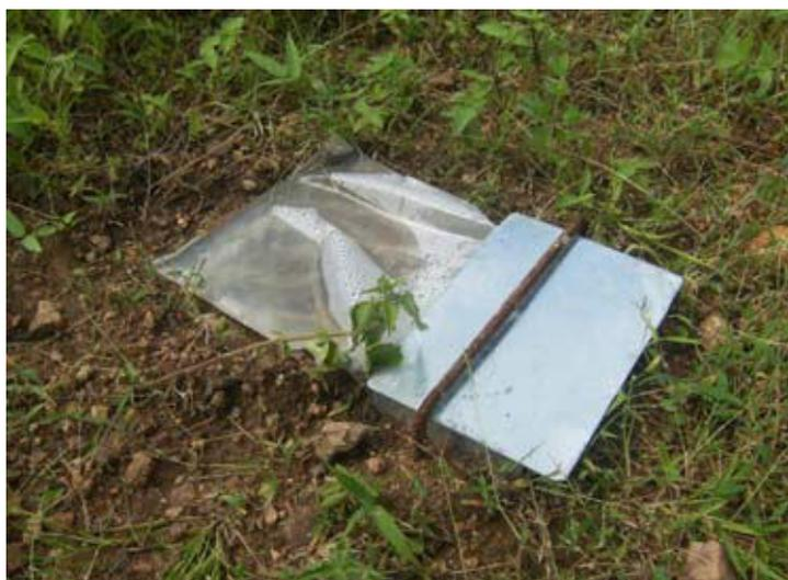
**FOTO 3.01** – Coletor de solo e água.
