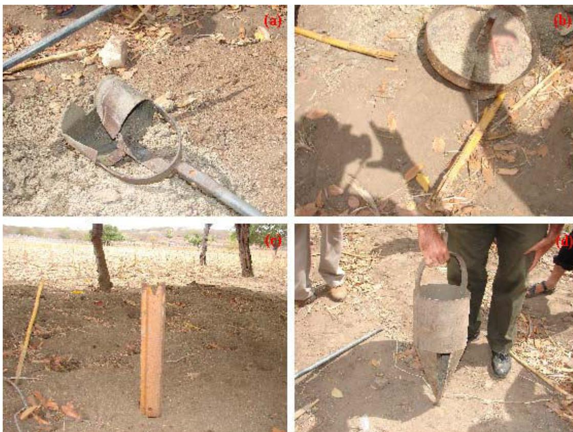
**FOTO 2.20** – Equipamentos utilizados nas sondagens dos aluviões: (a) – coletor de pedras; (b) – copo para areia seca; (c) – rompedor; e (d) – copo para material argiloso.
