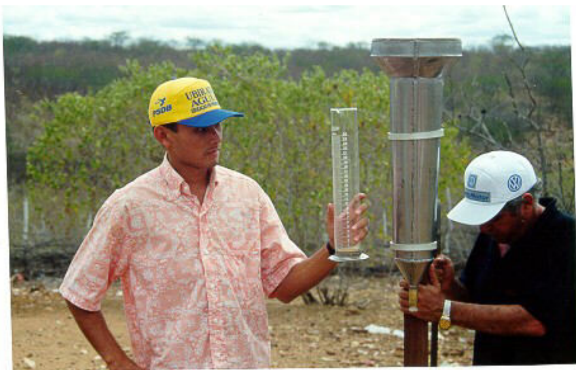
Figura 7: Proveta para determinação do total precipitado.
