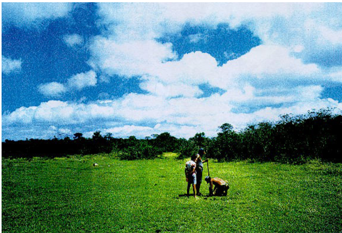
Perfuração a trado para verificação da espessura e granulometria do Depósito Aluvial
