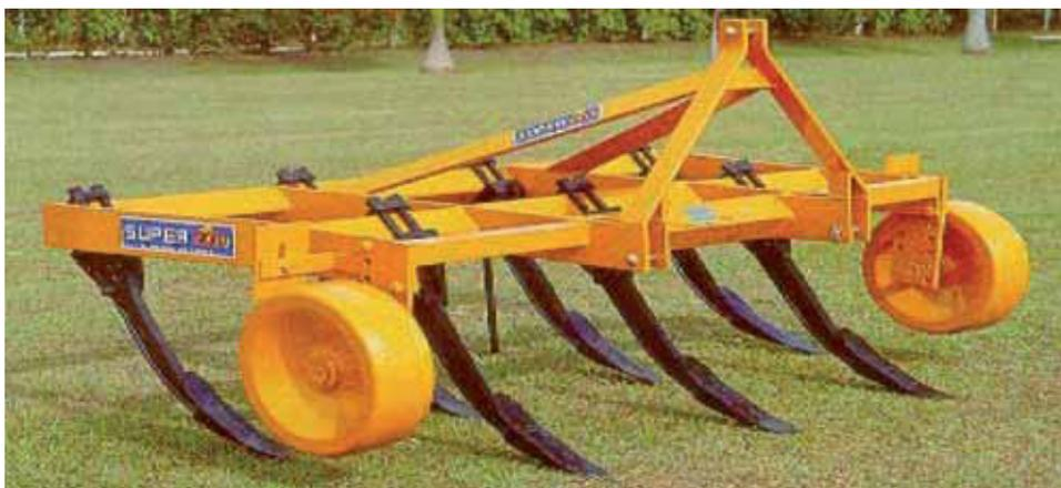
**Foto 33 - Subsolador para Descompactação Profunda**
