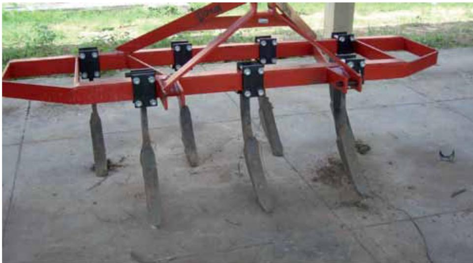
**Foto 32- Escarificador para descompactação superficial**
