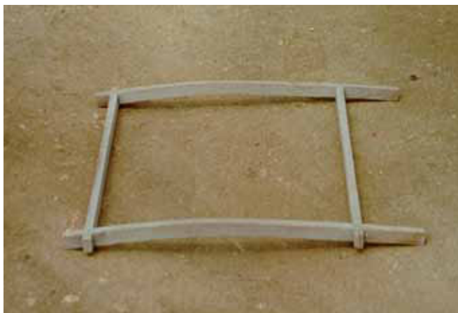
Foto 1 – Gabarito das placas das paredes da cisterna Fonte: Equipe técnica do PRODHAM.
