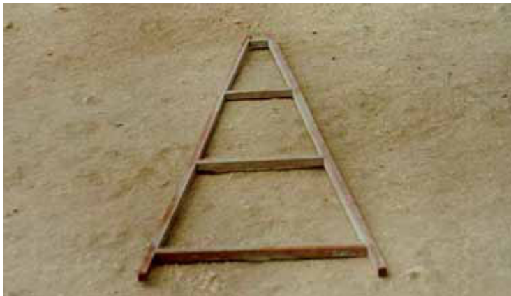
Foto 3 – Gabarito das placas da tampa da cisterna
