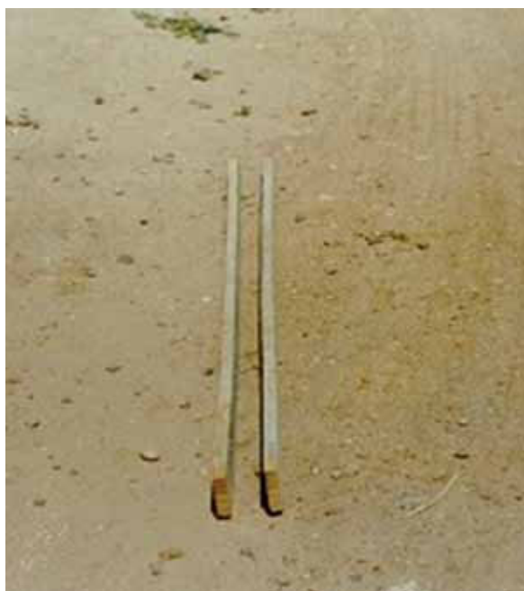
Foto 2 – Gabarito dos trilhos da tampa da cisterna Fonte: Equipe técnica do PRODHAM.
