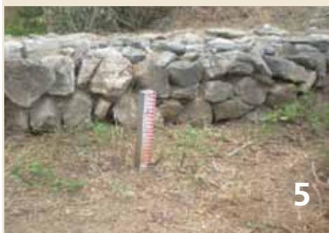
Foto 5 – Instalação da régua a montante do microbarramento para medir o volume de sedimentos.
