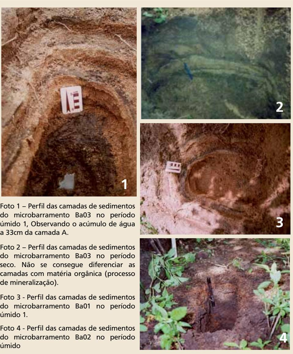
Foto 1 – Perfil das camadas de sedimentos do microbarramento Ba03 no período úmido 1, Observando o acúmulo de água a 33cm da camada A.
