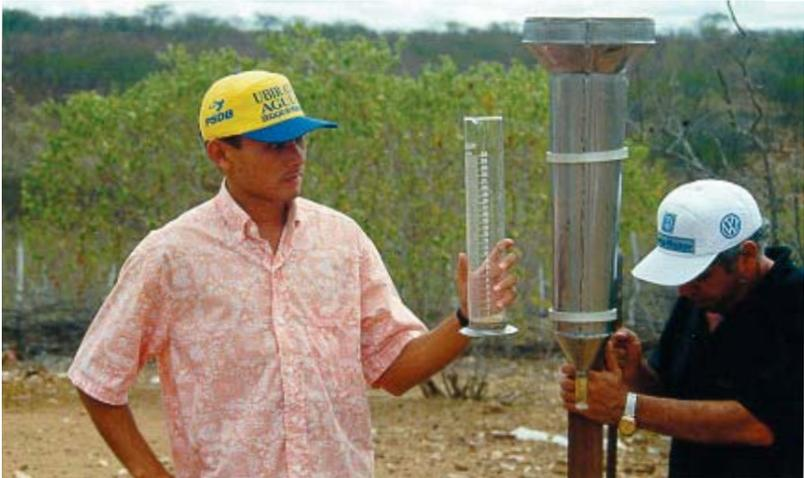
**Foto 1 – Instalação do Pluviômetro para Acompanhamento das Precipitações nas Microbacias**
