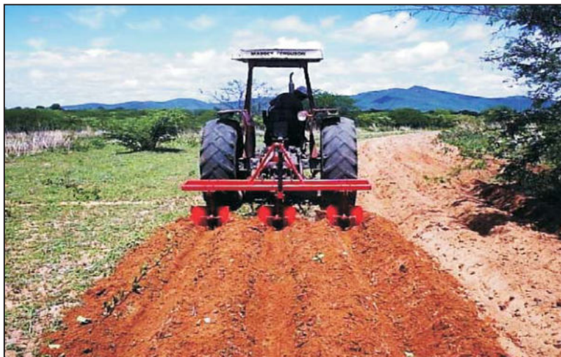
Foto 7 – Sulcamento com Sulcador de 3 Linhas
