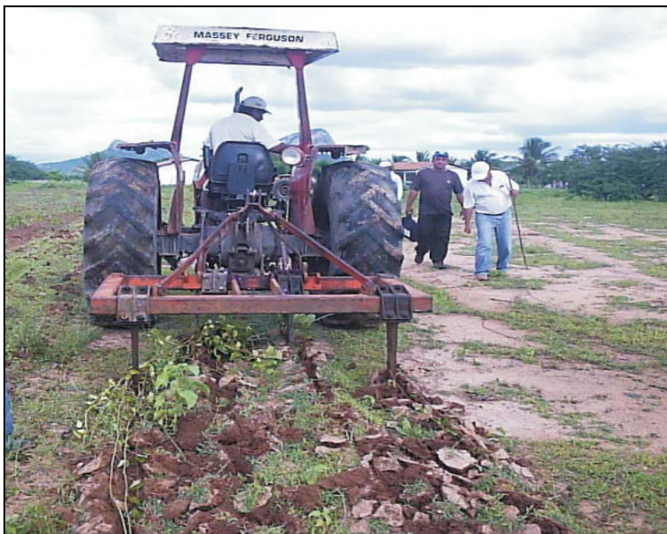
Foto 3 – Subsolador Quebrando o Adensamento de Subsuperfície, Quixeramobim-CE
