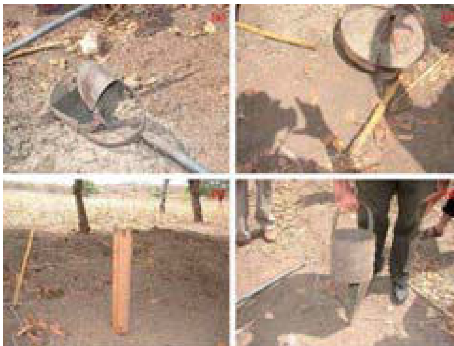
FOTO 2.20 – Equipamentos utilizados nas sondagens dos aluviões: (a) – coletor de pedras; (b) – copo para areia seca; (c) – rompedor; e (d) – copo para material argiloso.
