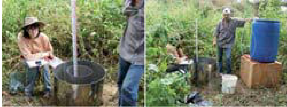
FOTO 2.10 – Ensaio de infiltração com anéis concêntricos
