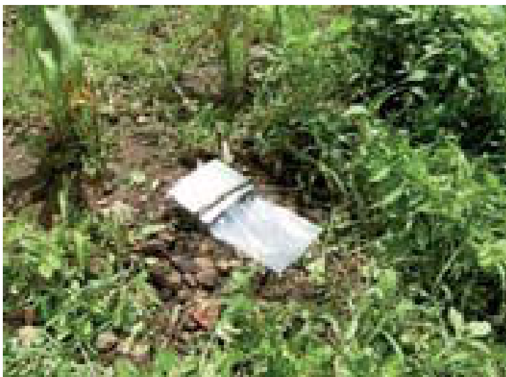
FOTO 3.04 – Vista por cima de um coletor instalado com saco fixado.
