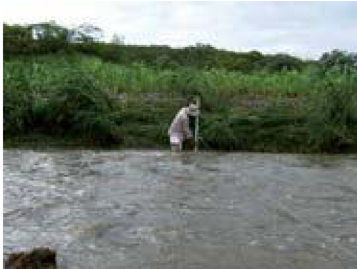
FOTO 2.17 – Marcação das estações ao longo da seção transversal do rio
